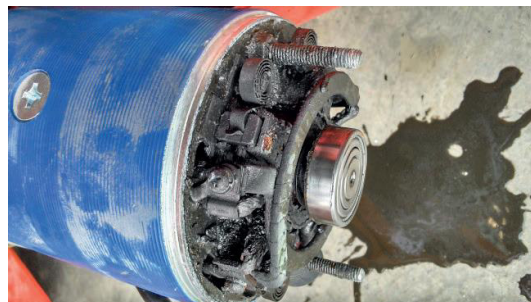
Wasserschaden an Antriebsmotor
