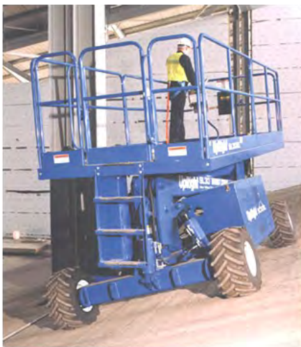
SL 30SL, Diesel 4x4, Nivellierung
