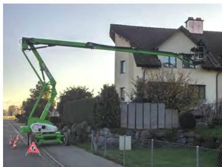
HR 21 4x4, Hybrid, Diesel + Batterie
