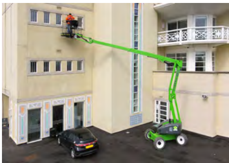
HR 15 4x4, Hybrid, Diesel + Batterie
