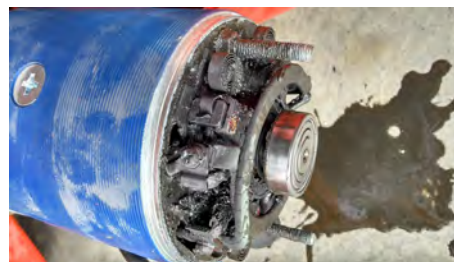
Wasserschaden an Antriebsmotor
